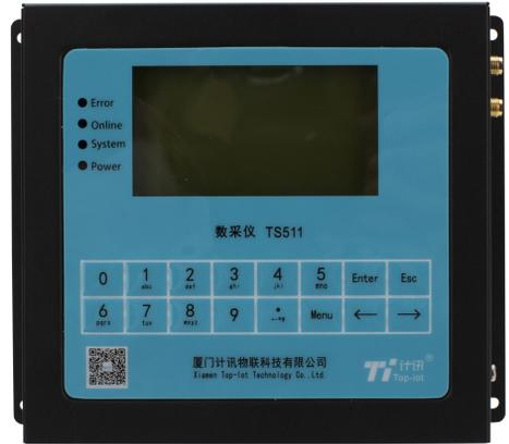
TS511系列采集终端是集数据采集与4G数据传输功能于一体的环保数据采集终端，采用嵌入式设计方案，满足多样的环保数据采集需求，完全符合《污染物在线自动监控(监测)系统数据传输标准》(HJ 212-2017) 和(HJ 212-2005)，适用于环境和污染源在线监测设备监测数据的采集、存储和传输。广泛适用于VOCs在线监控系统、污染源在线监控、废气在线监控、水质污染溯源监控、生态环境质量等环保监测领域。
